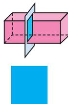
Сечение плоскостью под определённым углом к плоскости основания через противоположные грани.
