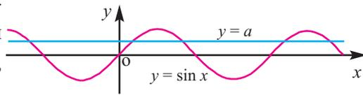
на всей числовой оси для функции  $y = \sin x$  нет обратной функции. Однако, на отрезке  $[-\frac{\pi}{2}; \frac{\pi}{2}]$   $y = \sin x$  возрастает и от  $-1$  до  $1$  принимает все значения, а также каждому значению аргумента соответствует единственное значение функции. Значит, на отрезке  $[-\frac{\pi}{2}; \frac{\pi}{2}]$  функция  $\sin x$  обратима и при  $|a| \leq 1$  уравнение  $\sin x = a$  на отрезке  $[-\frac{\pi}{2}; \frac{\pi}{2}]$  имеет единственный корень.
